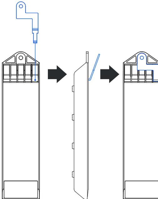
2. Setze die gezackte Unterlegscheibe auf die Stange in der Säule ein. Sie sollte zwischen der Metallsäule und der Power Rail platziert werden.
