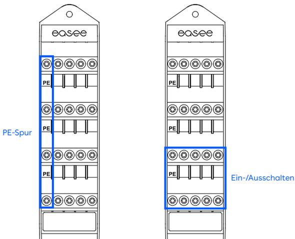
Wir empfehlen die Verwendung der beiden oberen Anschlussätze für die Ladekabel.
